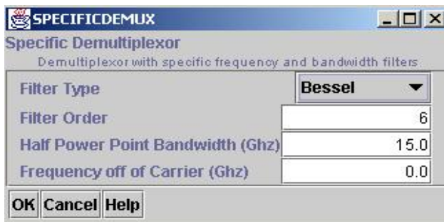
Figure 43 User Specified Demultiplexer Parameter Box
